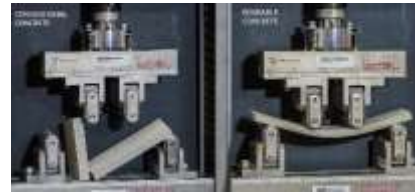
3-rasm. Namunalarni egilishga sinash(chapda oddiy beton, o'ngda ECC)
