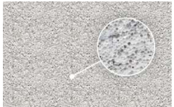
2-rasm. Gazobetonlardagi g'ovaklarning ko'rinishi
