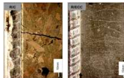
1-rasm. Oddiy temirbeton va ECC da yuklama ta'sirida yoriqlar hosil bo'lishidagi farqlar
