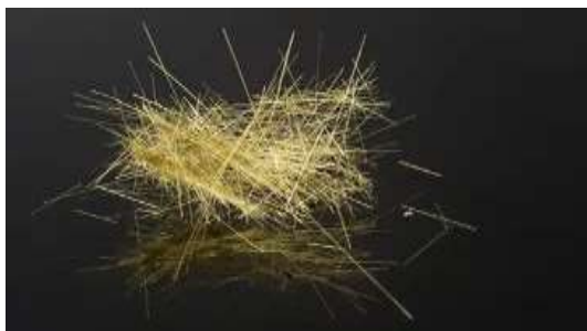
1-rasm. Fibrobeton namunasi va bazalt tolasi tasviri.
