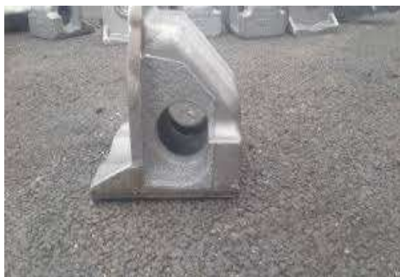
Рис.2. Фрикционный клин гасителя колебаний из синтетического чугуна в одноразовой песчаной форме
