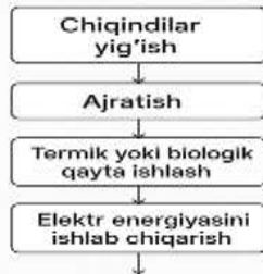
Chiqindilarni qayta ishlash sxemasi
