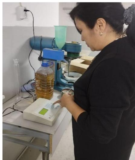
Рис. 3. Процесс определения удельной поверхности на ПСХ-11
