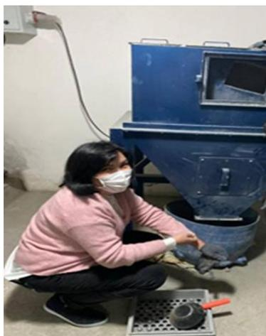
Рис. 2. Процесс измельчения речного песка
