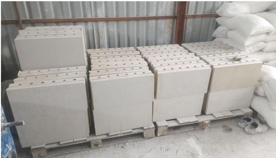
Рис. 1. Пазогребневые плиты (ППП), производимая в СП "Норкулов-Муборак"
