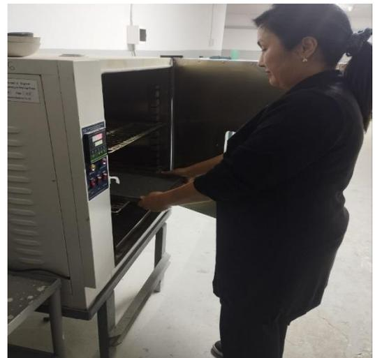
Рис. 1. Процесс сушки речного песка Куйлюкского карьера
