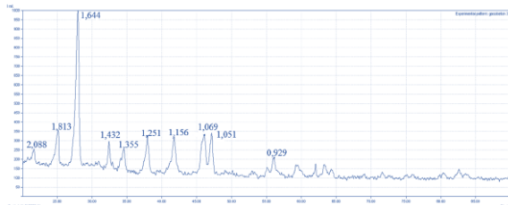
4-rasm. Po'lat eritish shlak yordamida tayyorlangan gazobetonning kimyoviy o'zgarishning rentgen-strukturaviy tahlili
