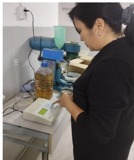
Рис. 3. Процесс определения удельной поверхности на ПСХ-11
