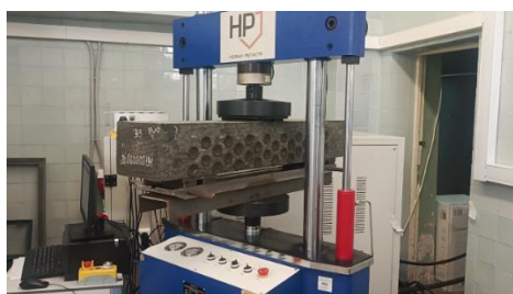
Рис. 1. Испытание образца композитной шпалы на циклическую нагрузку
