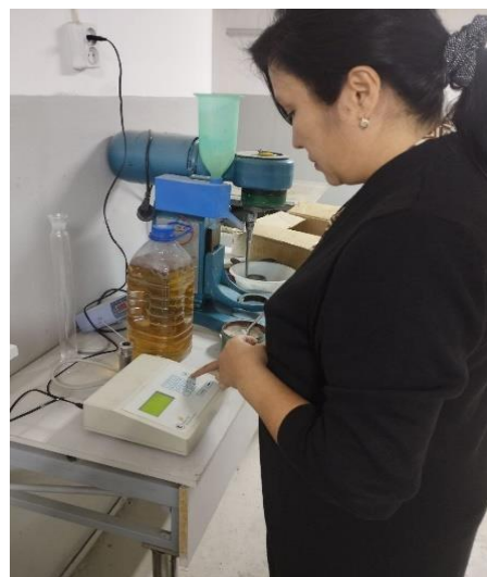
Рис. 3. Процесс определения удельной поверхности на ПСХ-11
