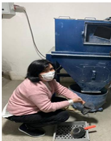
Рис. 2. Процесс измельчения речного песка
