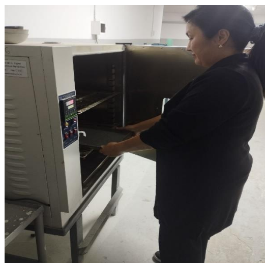
Рис. 1. Процесс сушки речного песка Куйлюкского карьера
