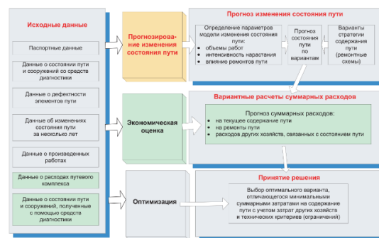
Рис. 1. – Схема методики среднесрочного прогнозирования и планирования ремонтов пути [4]
