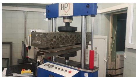
Рис. 1. Испытание образца композитной шпалы на циклическую нагрузку
