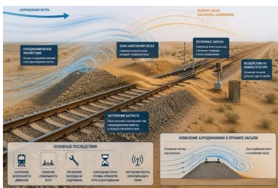
Рис. 1. Воздействие пустынных ветров на железнодорожный путь
