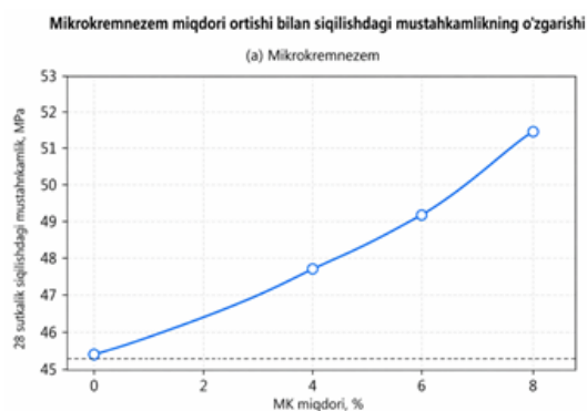
Рис. 3.1. Прочность от количества микрокремнезема
