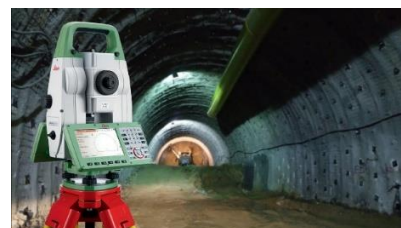
7-rasm. Tunnel qoplamasining deformatsiyalari va holatini nazorat qilishda lazerli taxeometrlarni qo‘llash
