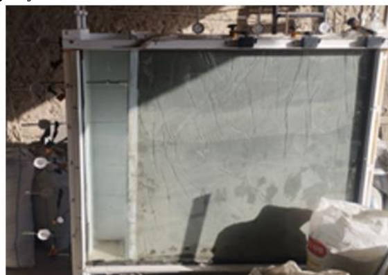
8-rasm. Bazalt matolarning gorizontaal va vertikal joylashuvining tirgak devaoga ta'sirni tadqiq etish jarayonidan lavhalar
