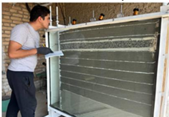
8-rasm. Bazalt matolarning gorizontaal va vertikal joylashuvining tirgak devaoga ta'sirni tadqiq etish jarayonidan lavhalar
