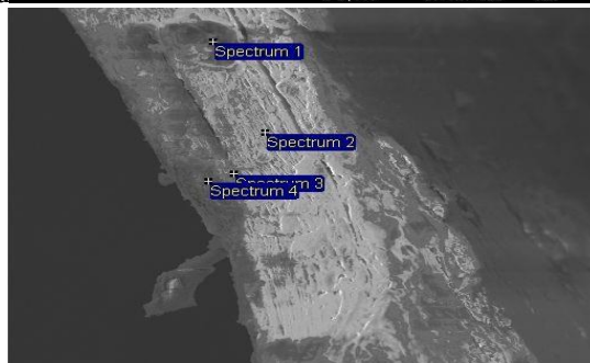
2-rasm. Namunaning sirt mikrostrukturasi yorilish tekisliklariga tik: a - ikkilamchi elektronlarda, 2000 marta kattalashtirilgan; b - spektr belgilari bilan, 1000 marta kattalashtirilgan
