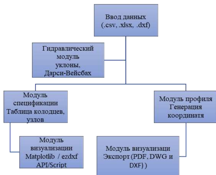
Рис. 1. Блок-схема архитектуры программного обеспечения автоматизации построения продольного профиля
